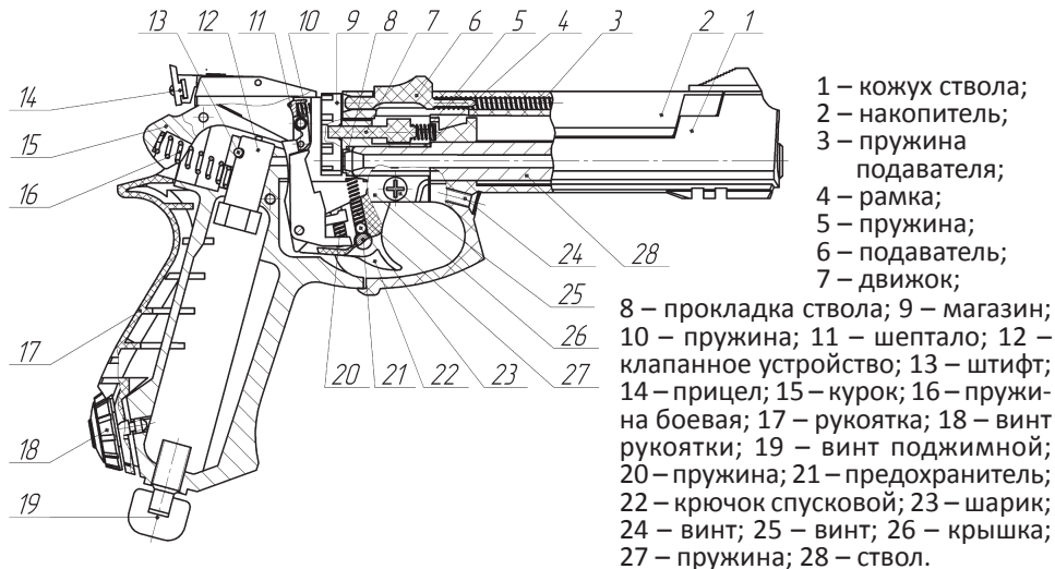
Рисунок А.2 – Схема механизмов pistols MP-651K, MP-651K
