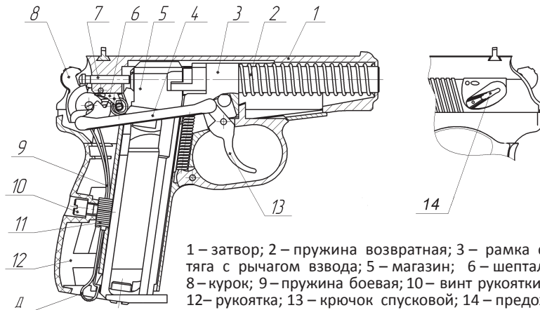
Рисунок 2 – Схема механизмов пистолета MP-654K
