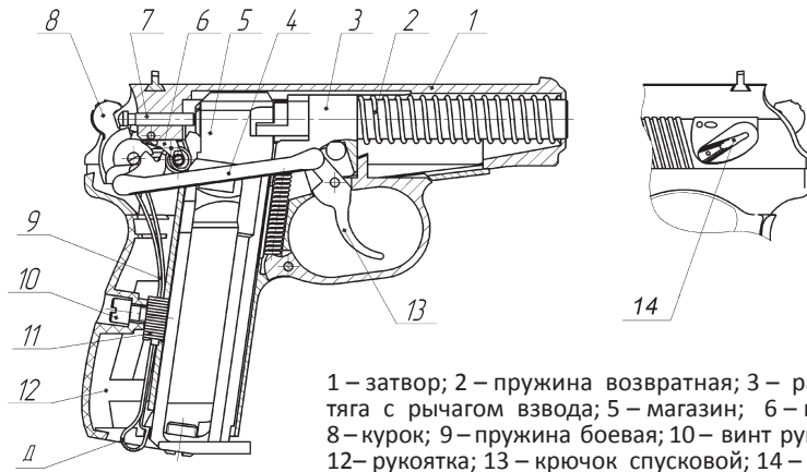
Рисунок 2 – Схема механизмов пистолета MP-654K
