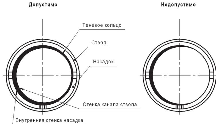
Рисунок 4 – Положение дульного насадка в стволе
